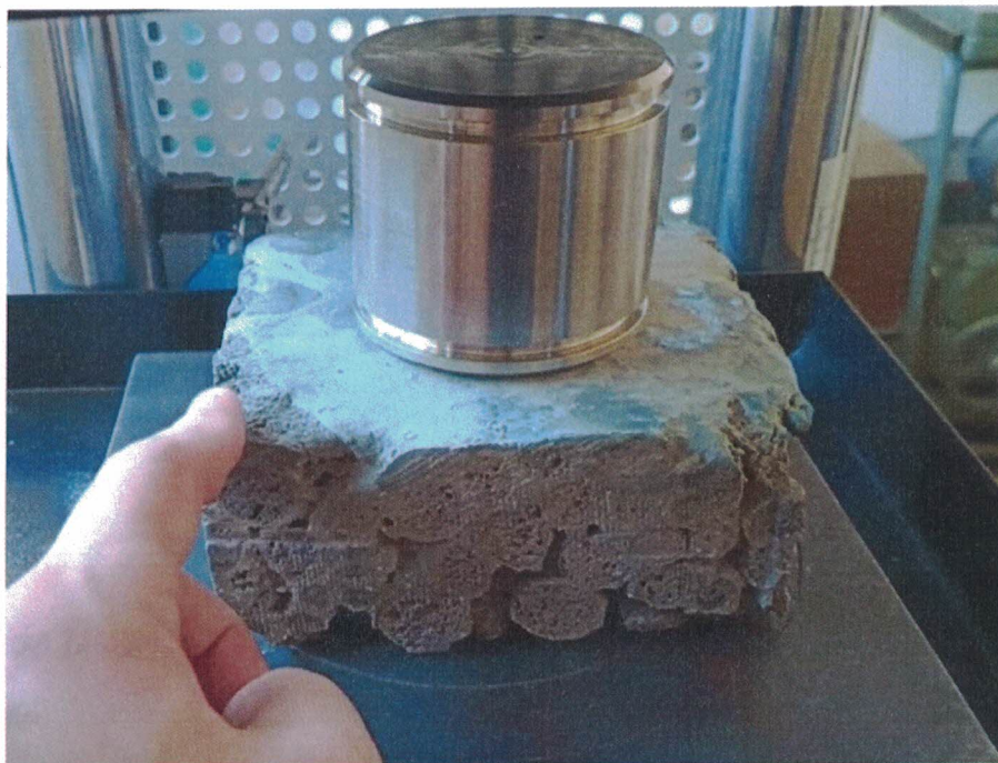
Рисунок 2. Неустойчивость образца при установке на опорной плите прессы, обусловленная локальной неровностью нижней грани образца № 3.
